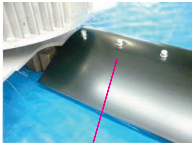
Parte superior de la pala fijada por medio de tuercas de seguridad
